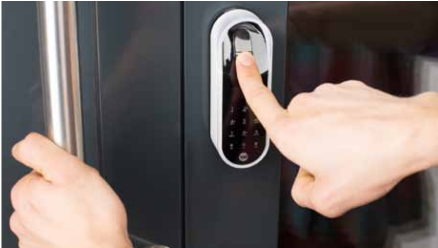
Bild 4: Der elektronische Schließzylinder »Entr« bindet die private Haustür in ein Smart Home ein
