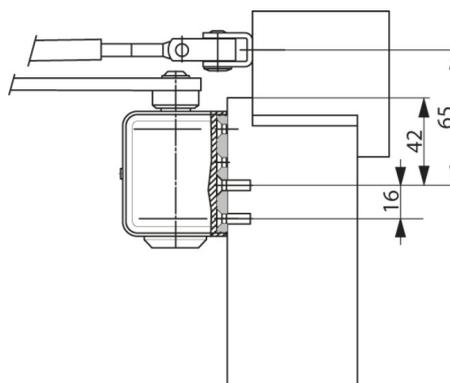
Zur Befestigung auf Bohrbild DIN EN 1154 Beiblatt 1 (Feuer- und Rauchschutztüren) und zur universellen Verwendung.
