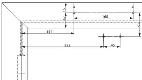
Schließer am Türrahmen auf der Bandgegenseite. Für Türen, bei denen eine Direktbefestigung nicht möglich ist.
