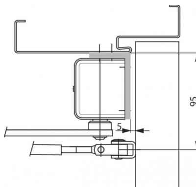
für die Kopfmontage bei tiefer Leibung, Durchgangshöhe wird um 70 mm reduziert.
