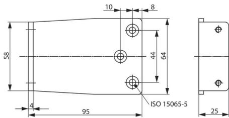
für Parallelarmmontage für die Gestängebefestigung bei PA-Montage.
